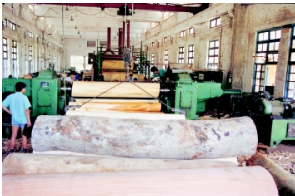
Transformation de grumes tropicales dans un usine de contreplaqués en Chine. Photo: Hou Yuanzhao
