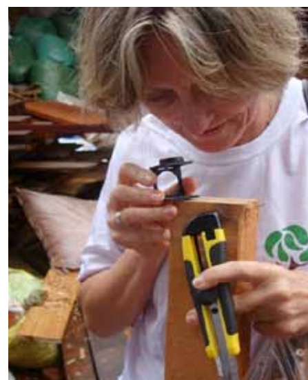
Au Brésil, dans une scierie de Brasília, une anatomiste du bois identifie un sciage avant de procéder à une mesure NIRS. Photo: Tereza Pastore
