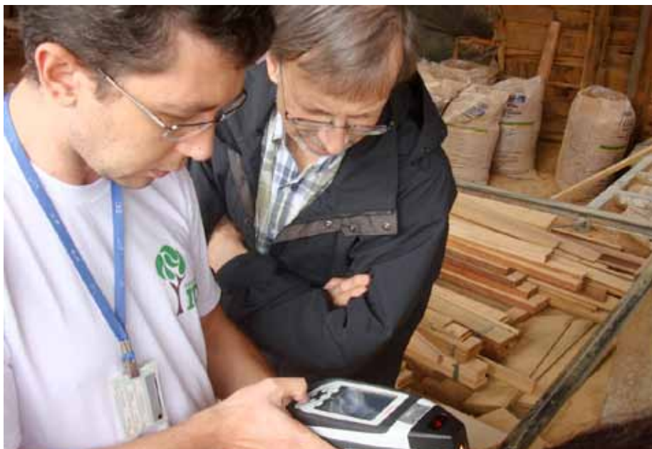
Mise à l'essai du spectromètre NIR portable et du modèle statistique dans une scierie à Brasília au Brésil (M. Jez Braga à g. et M. Ian Thompson à d.). Photo: Tereza Pastore
