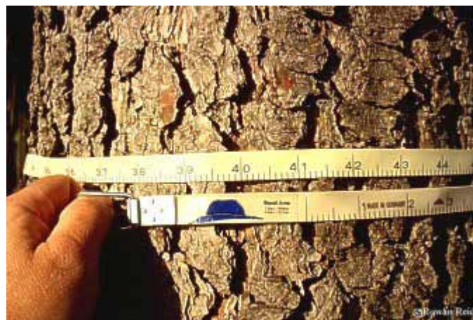
Gambar 12. Teknik pengukuran diameter dengan MTG ( Measuring Tree Girth )
