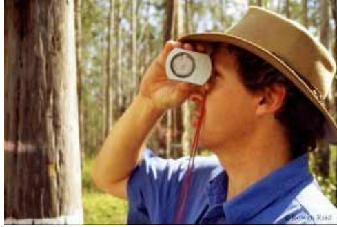
Gambar 20. Teknik pengukuran tinggi pohon dengan Clinometer
