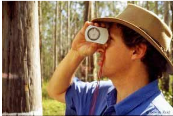
Gambar 22. Teknik pengukuran tinggi pohon dengan Clinometer
