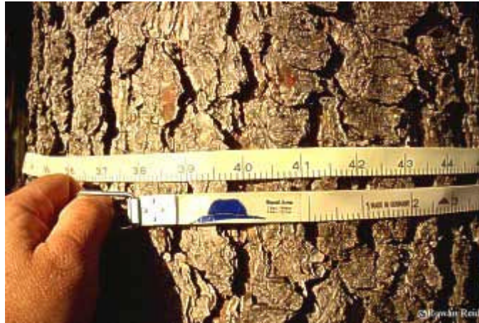
Gambar 14. Teknik pengukuran diameter dengan MTG ( Measuring Tree Girth )
