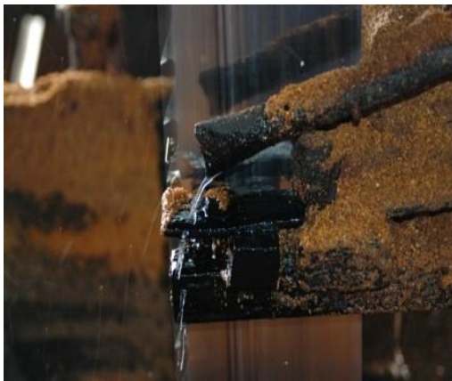
Photos 17-18 (ISWA): Refroidissement inapproprié d'une scie à ruban (17); Utilisation d'une échelle endommagée (18)
