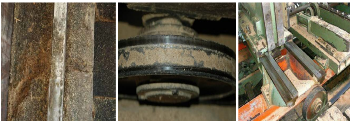
(7) (8) (9) Photos 7-9 (S. Y. Kim): Rail endommagé (7); Roue dépourvue de raclor (8); Chariot à grumes non entretenu (9)
