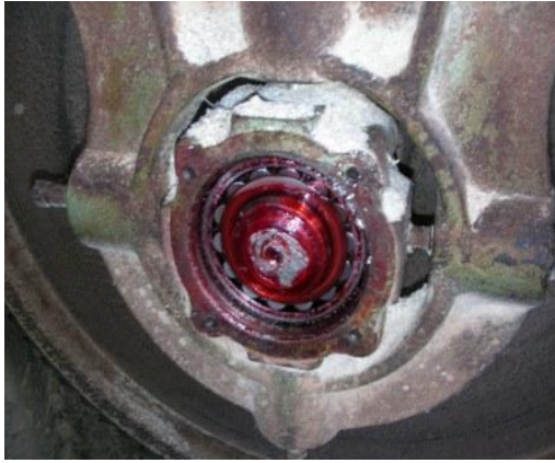
Photos 15-16 (ISWA): Emploi d'un type de graisse inadapté
