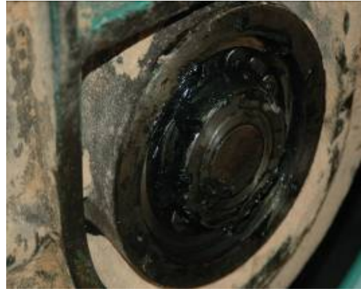
Photos 15-16 (ISWA): Emploi d'un type de graisse inadapté
