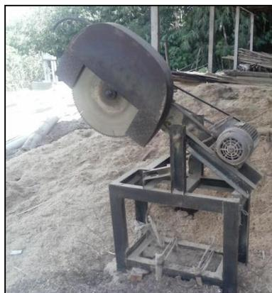
Gambar 12. Mesin Gergaji Pemotong Bambu
