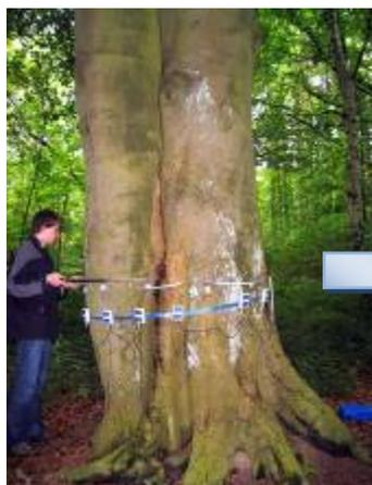
Foto 6: Medición con el Tomógrafo sónico
