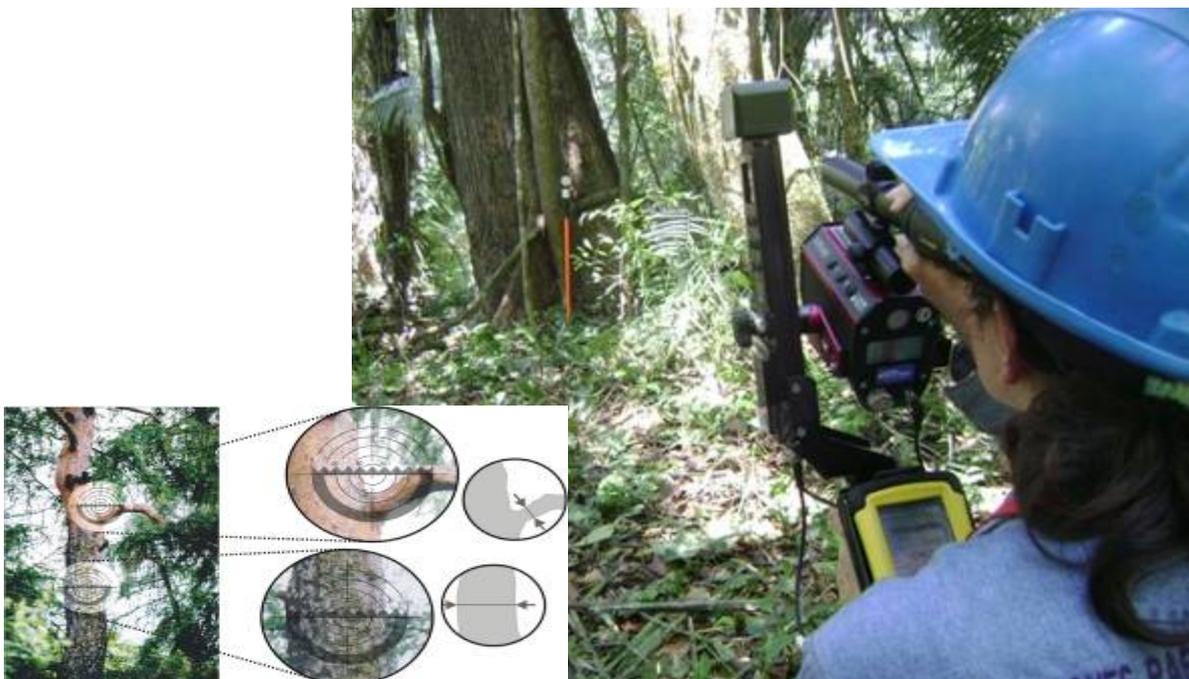
**Foto 2: Medición de las caobas con relascopio electrónico de la tecnología Field Map LT**
