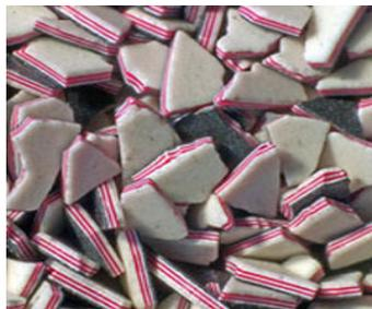
*Figura: Microtaggant partículas codificadoras el tamaño de las partículas reales llegan hasta 20 micras.*
