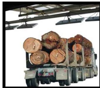
*Figura. Camion transportando trozas usando un portal RFID.*
