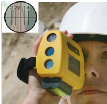
*Laser Acer3D, es un equipo que mide altura, diámetro y volumen, incluye brújula digital. Las mediciones y cálculos se muestran en una pantalla retroiluminación del panel LCD. La salida de datos es a través de Bluetooth®. El LaserACE 3D® puede ser configurado para conectarse a una amplia gama de registradores de datos, la palm y Pen.*
