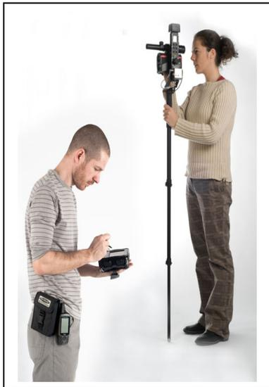
**SWAN:** El peso del equipo se distribuye entre dos trabajadores. Los dispositivos de medición se conectan al ordenador mediante conexión inalámbrica Bluetooth.
