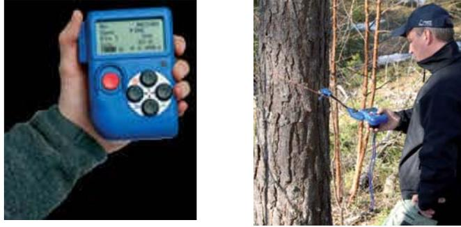
**Figura:** *Digitech Pro one. Forcípula digital con láser, para usar con una sola mano. El equipo le permite una vez medido el diámetro, introducir otros datos como alturas, especie de árboles etc. El láser rojo que incorpora no causa daños a personas ni animales.*
