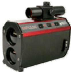
*Fig. El IIMPULSE 200 modelo estándar incluye un sensor de inclinación, lo que el láser de la capacidad para calcular distancias horizontales y verticales, así como valores de altura. El modelo 200 incluye de serie con un punto rojo 1x ámbito de aplicación, pero se puede actualizar con un alcance de 1,5 4x*
