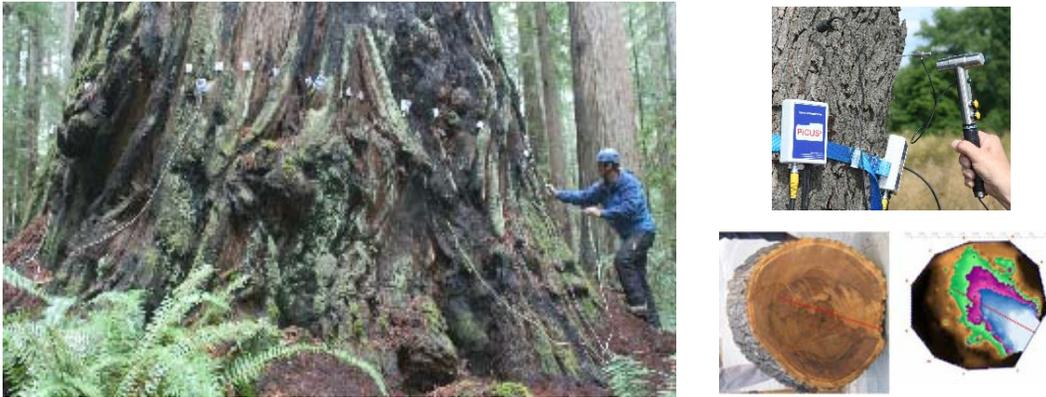
**Tomógrafo ARBOTOM®:** Trabaja de forma no destructiva con ondas de impulsos que son detectadas por los sensores que se sitúan en el árbol. Pueden investigarse árboles de todas dimensiones. Las áreas del tronco debilitadas son detectadas y mostradas en forma gráfica en 2D o 3D. El resto del tronco puede ser investigado a través de la sección transversal completa. De este modo, la seguridad ante posibles roturas de un tronco puede ser evaluado. ([www.geonatura.com](http://www.geonatura.com))
