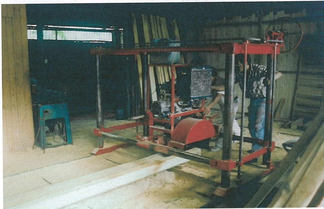
Pruebas de aserrío en taller artesanal, con motor usado de marca Daewoo de auto Tico
