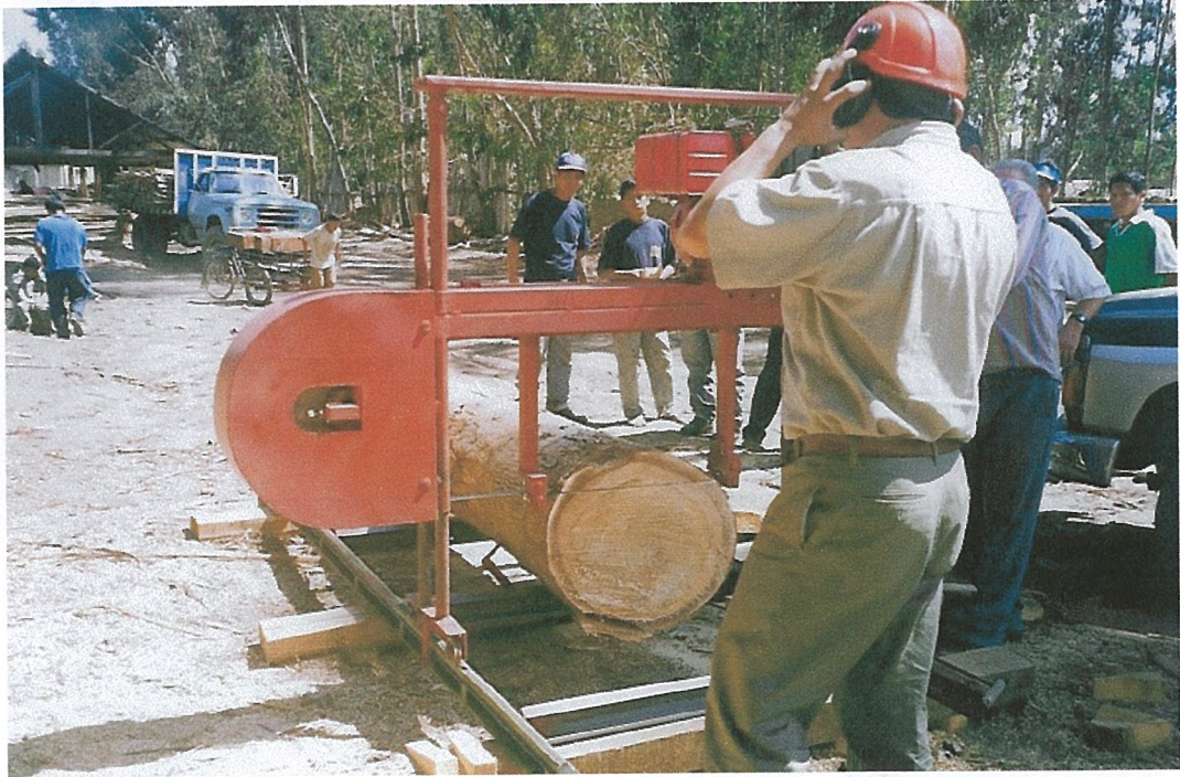
Aserradero Portátil Marca Schuler con motor B&S de 16 Hp para madera pequeñas
