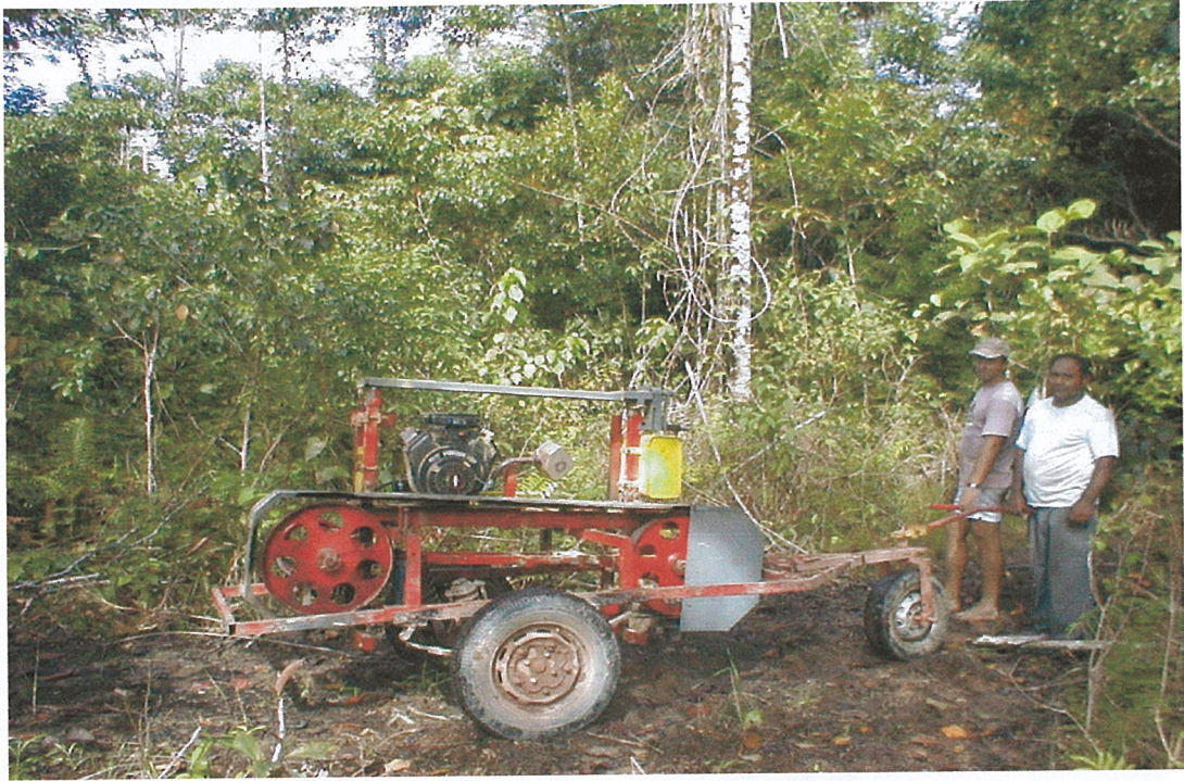
Aserradero Portátil Schuler, en carro de transporte, diseñado para múltiples usos, carga aserradero y transporta la madera aserrada
