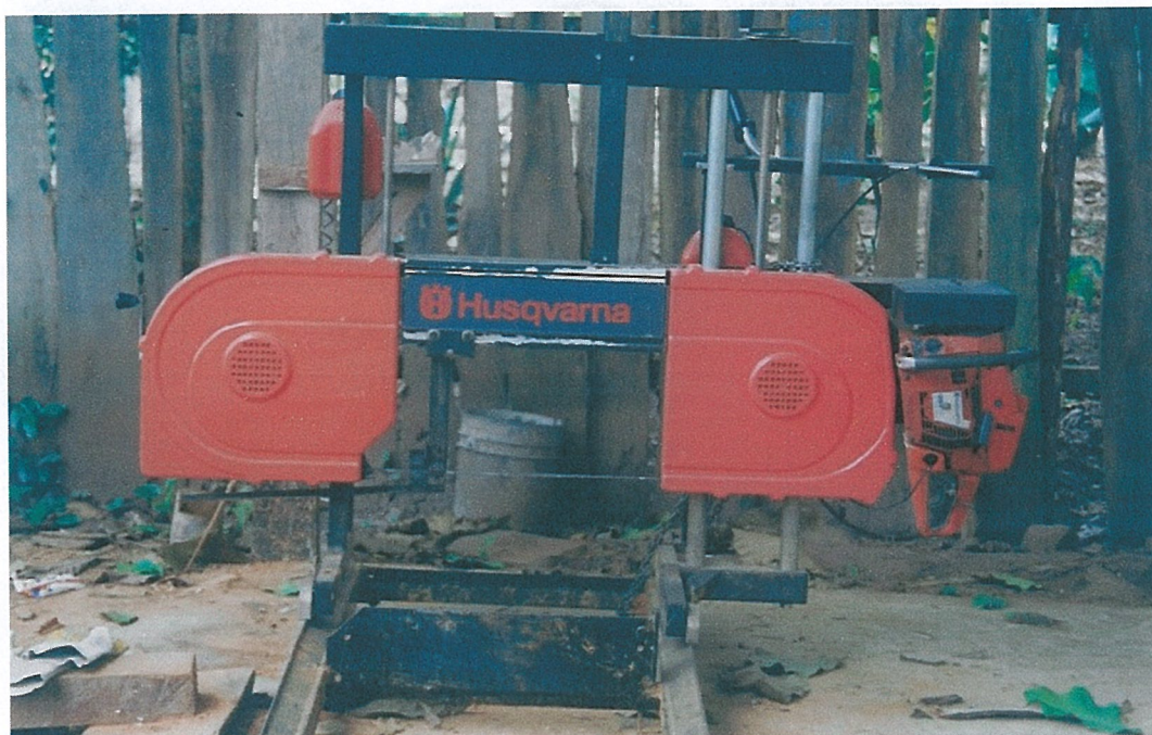
Las limitaciones del aserradero para aserrar maderas mayores de 50 cm de diámetro
