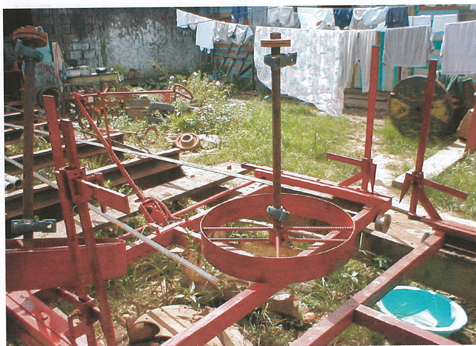
Partes y piezas del aserradero portátil, construido en taller artesanal de Puerto Maldonado en la Región Madre de Dios.
