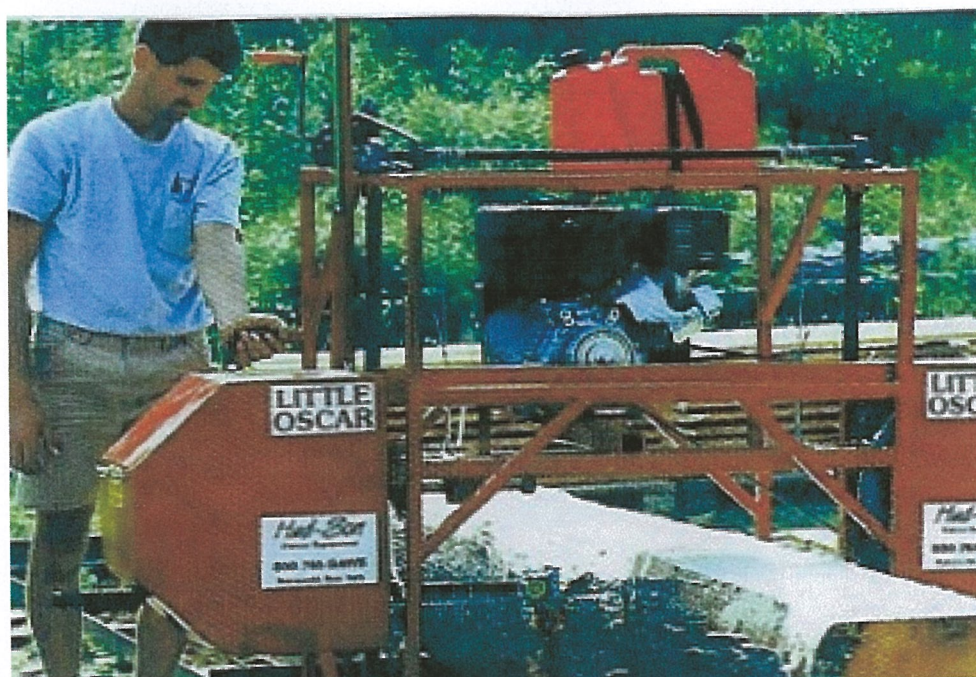
Aserradero portátil de reciente incorporación al mercado nacional, Presenta un motor de solo 13 Hp y trabaja trozas de hasta 50 cm de diámetro
