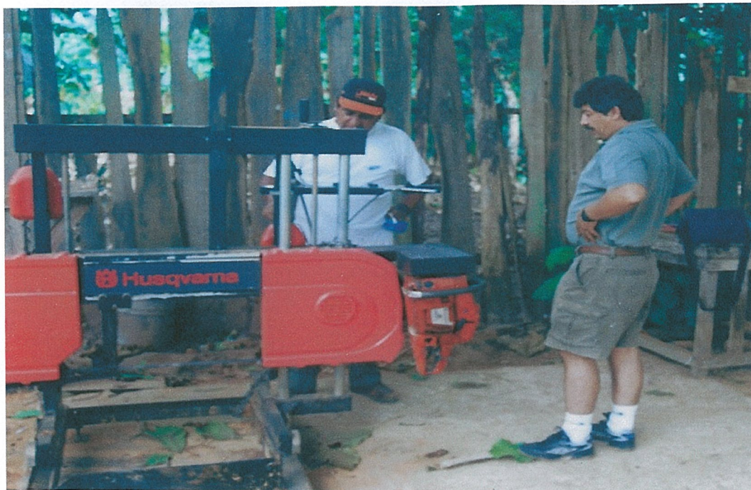
Aserradero muy pequeño accionado con motor de motosierra
