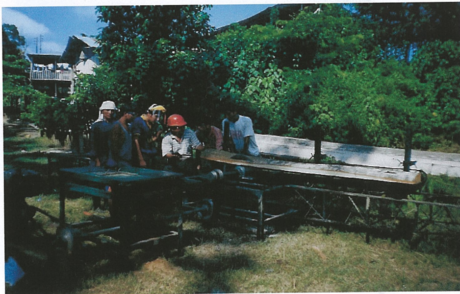
La capacidad permite solo trabajar con cuarterones aserrados con motosierra por el sistema de aserrío longitudinal
