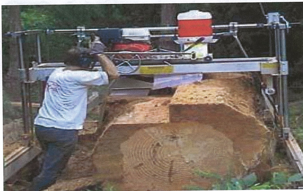
Aserradero Petterson en pleno trabajo de demostración
