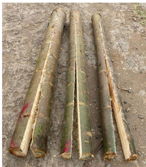
Des grumes de balsa de 18 mois d'âge font l'objet d'un test de fissurage dans la région nord du Costa Rica. © Róger Moya
