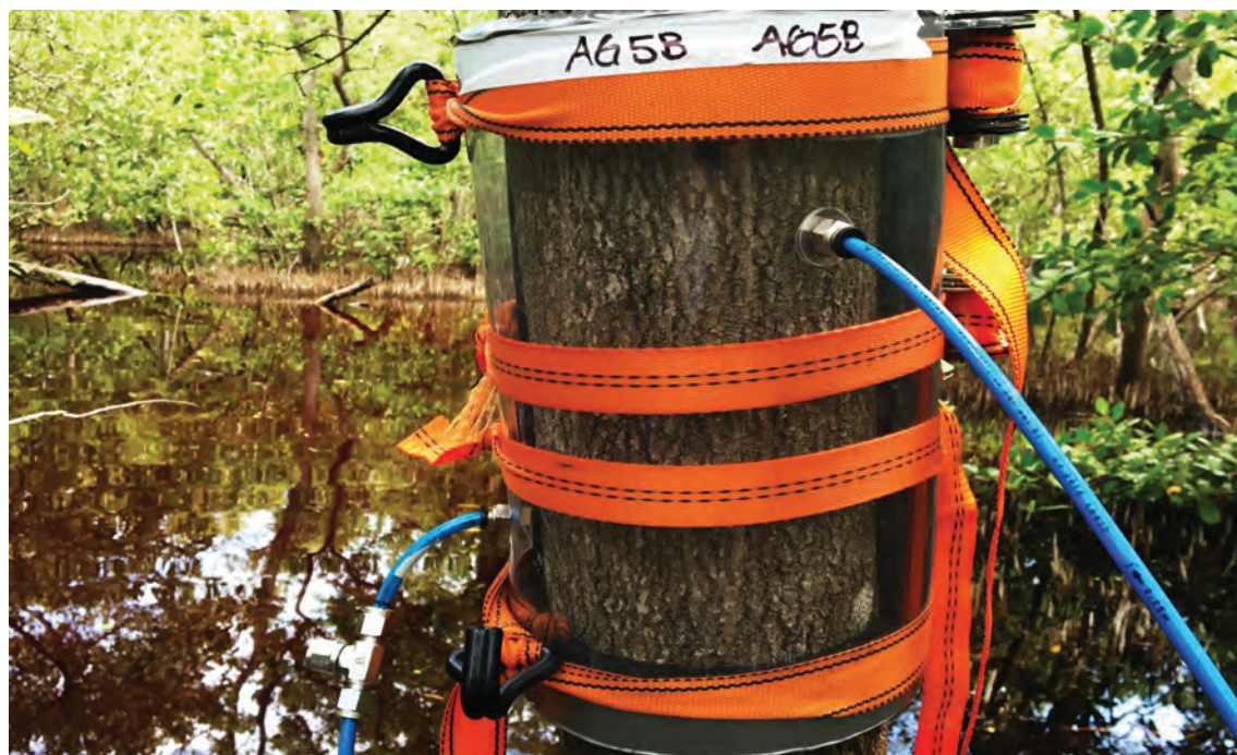
Des racines qui respirent: mesure des flux de gaz à effet de serre sur la tige d'un arbre dans une mangrove de la péninsule du Yucatán, au Mexique. Photo: Julio A. Salas-Rabaza
