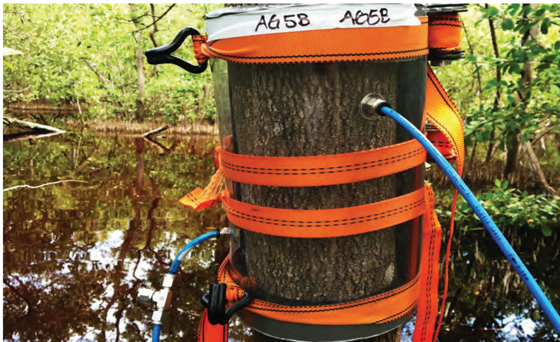
Raíces que respiran: Medición de los flujos de gases de efecto invernadero desde el tronco de un árbol en un manglar de la península de Yucatán, México. Fotografía: Julio A. Salas-Rabaza
