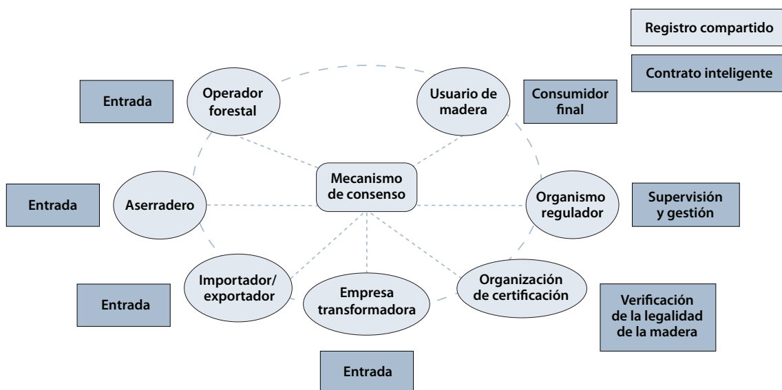
Figura 1: Marco conceptual para un sistema de trazabilidad de maderas basado en cadenas de bloques
