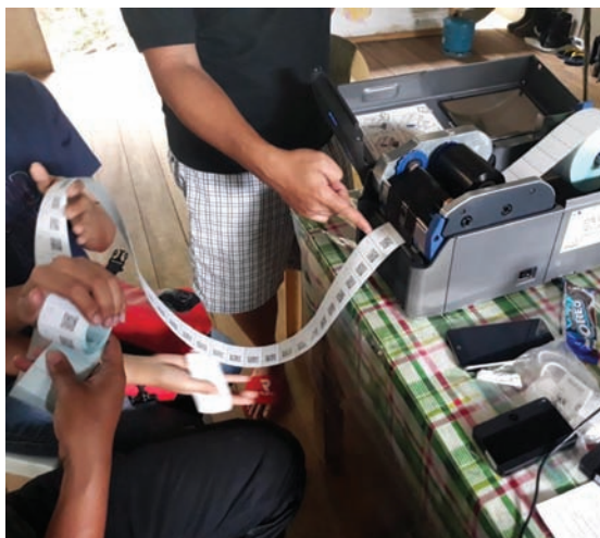
Código de madera: Una máquina en un aserradero de Bukidnon imprime etiquetas con el código QR, que deben colocarse en cada pieza de madera en el aserradero. Fotografía: FMB
