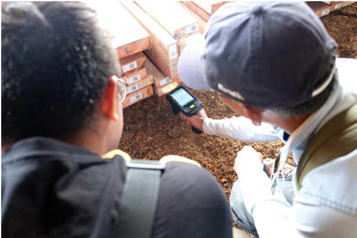
フィリピンにて、ITTOプロジェクトで木材追跡用に開発されたシステムの一部であるハンディサイズのRFIDリーダーは、在庫確認済みの木から生産された材木に付されているQRコードの読み取りに使用される。写真提供：森林管理局 (Forest Management Bureau)
