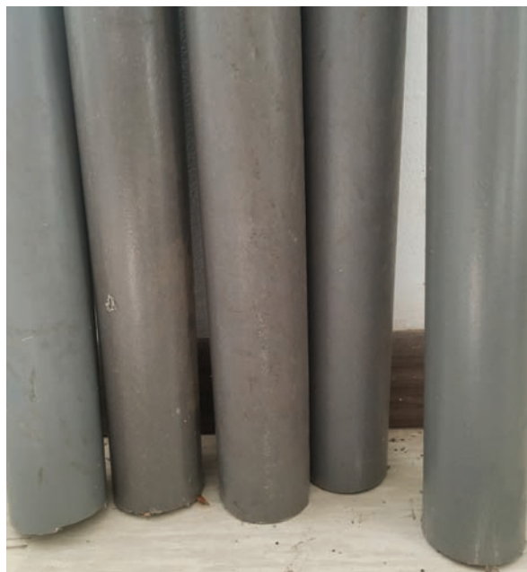
Dans les tuyaux: Les produits testés fabriqués à partir de sciure et de PVC. Photo: J.-B. Saha Tchinda
