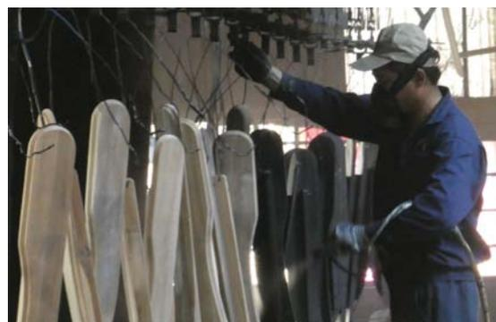
**Transformación:** Un obrero pinta componentes de muebles con aerosol en una fábrica de Da Nang, Viet Nam. Fotografía: J-C. Claudon/OIMT
