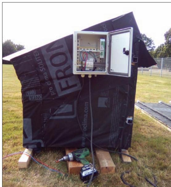
**A secas:** Un prototipo de colector solar en construcción en el Laboratorio de Estudios e Investigación de Materiales Leñosos en Epinal, Francia, para probar su rendimiento en el secado de madera. *Fotografía: Merlin Simo-Tagne*
