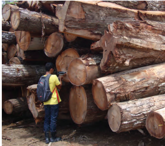
Scannage du bois: Diego Carvalho, un membre de l'équipe du projet, effectue un scannage SPIR directement sur une grume de cèdre dans une scierie de Seringal Novo Macapá. (État d'Acre) au Brésil. Photo: OIBT/LPF
