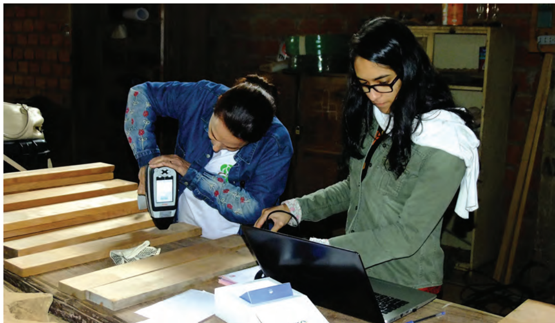
Sur zone: La collaboratrice du projet Tereza C. M. Pastore (à g.) et Liz F. Soares utilisent deux spectromètres différents pour identifier des échantillons de bois dans une scierie de Santa Cruz de la Sierra en Bolivie. Photo: OIBT/LPF
