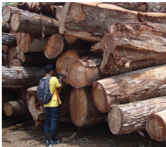
Lectura de madera: Diego Carvalho, miembro del equipo del proyecto, obtiene una lectura NIRS directamente de una troza de cedro en un aserradero del Seringal Novo Macapá, en Acre, Brasil.
