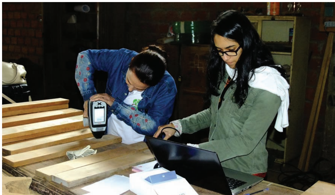
En foco: Dos miembros del equipo del proyecto, Tereza C.M. Pastore (izq.) y Liz F. Soares, utilizan dos tipos de dispositivos NIRS para identificar las muestras de madera en un aserradero de Santa Cruz de la Sierra, Bolivia. Fotografía: OIMT/LPF
