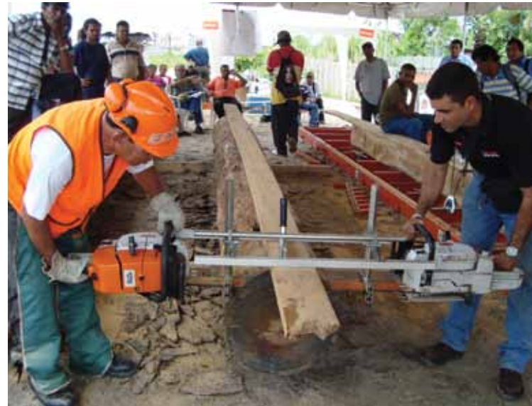
Dos instructores demuestran el uso de guías en el aserrado para aumentar las tasas de recuperación de madera como parte de la capacitación provista en el marco del proyecto PD 687/13 Rev.1 (I). Fotografía: P. Bholanath/ Comisión Forestal de Guyana
