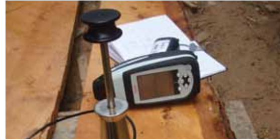
Este equipo se basa en la técnica de espectroscopía del infrarrojo cercano (NIRS) para la identificación de maderas como parte del proceso de seguimiento del comercio de caoba en Brasil. Fotografía: Laboratório de Produtos Florestais
