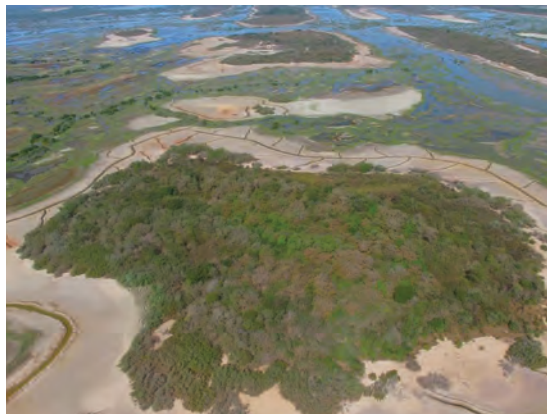
Drenaje llano: En este manglar degradado se instalaron canales para mejorar el flujo de agua, contribuyendo así al proceso de restauración. Fotografía: Ernesto Beltrán García
