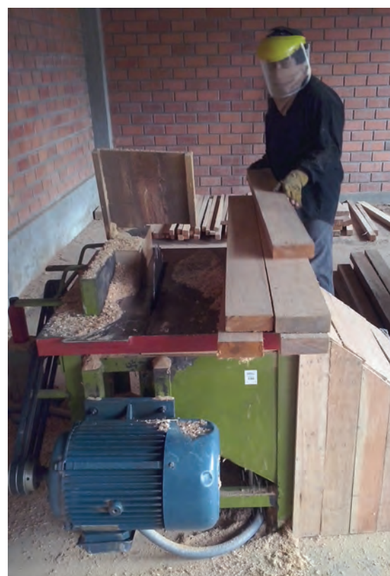
Travail de rabotage: Un ouvrier fabrique des débits rabotés dans l'usine de transformation Citeindigena SRL . Photo: AIDER
