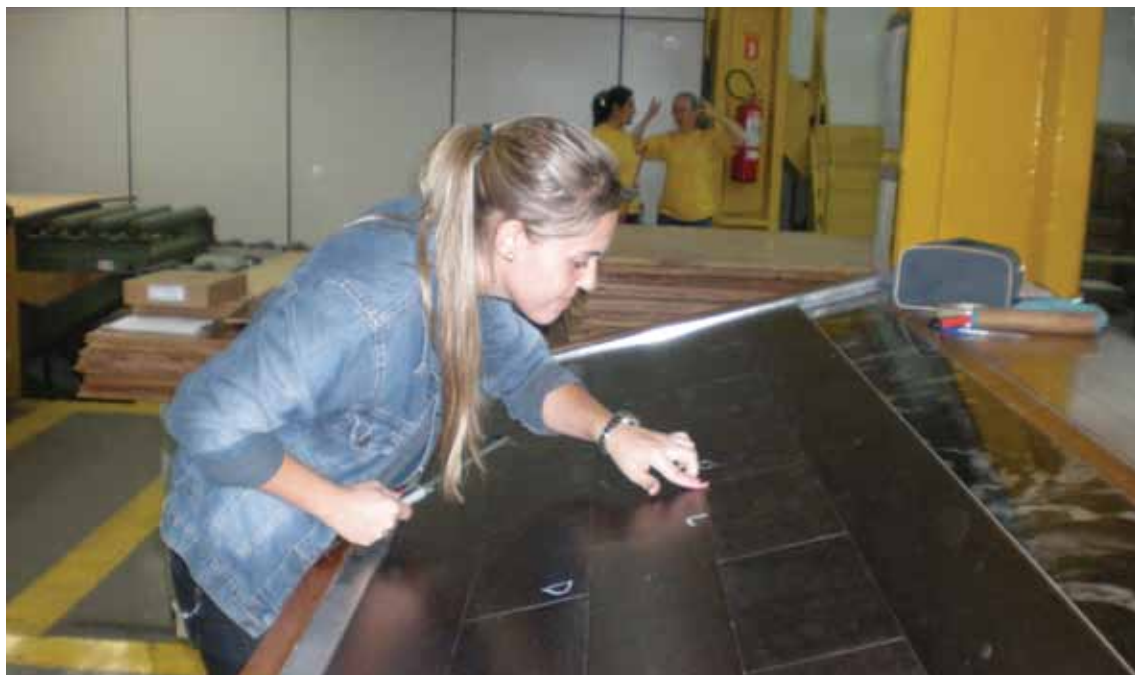
Passer la barre: Une spécialiste vérifie que la qualité d'un revêtement de sol en bois massif est conforme aux spécifications de l'ABNT. Photo: A. Andrade
