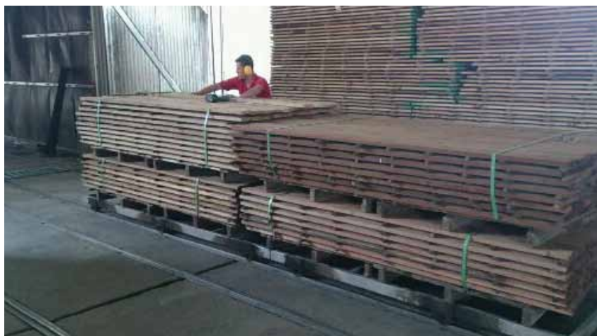
Pied au plancher: Des débités d'espèces moins utilisées préparés pour un séchage en séchoir sont fabriqués dans le cadre d'une activité industrielle pilote. Photo: I. Jankowsky
