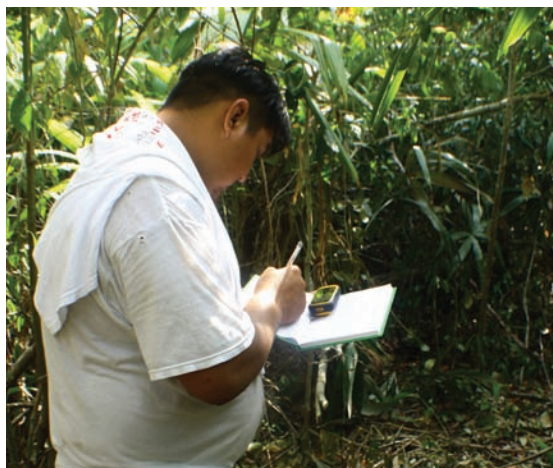
Planification des opérations d'extraction: Un ouvrier forestier utilise un appareil de positionnement par satellite (GPS) pour calculer les coordonnées géographiques des arbres sélectionnés pour l'extraction. Photo: C. Heindorf
