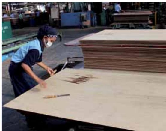
**Réparation d'un défaut:** Une ouvrière répare une feuille de placage de contreplaqué de meranti sur le site de l'usine. Photo: M. Y Massijaya
