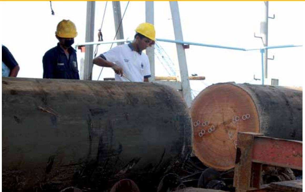
**Au berceau:** Des attaches en 8 sont fixées sur des grumes de meranti à contreplaqué pour réduire les fentes en bout dans un parc à grumes à Probolinggo en Indonésie. Photo: M. Y. Massijaya
