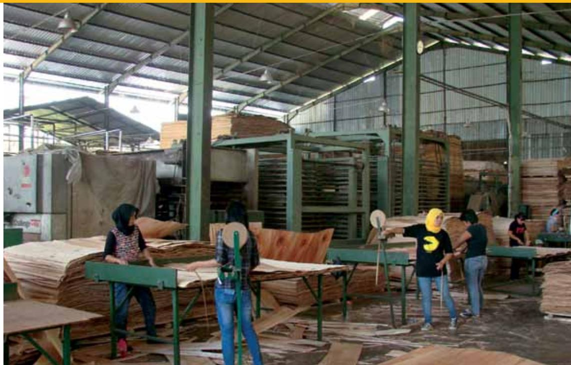
**Une main-d'œuvre intensive:** Réparation et assemblage de placages fabriqués à partir de grumes de petit diamètre dans une scierie de l'ouest de Java en Indonésie. Photo: Y. Zhou
