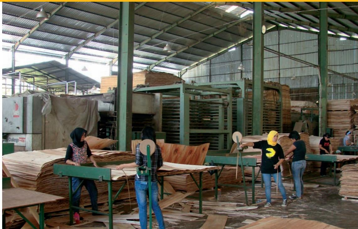
**Mano de obra intensiva:** Reparación y ensamblado de chapas fabricadas a partir de trozas de pequeño diámetro en una planta industrial de Java Occidental, Indonesia. Fotografía: Zou, Y.
