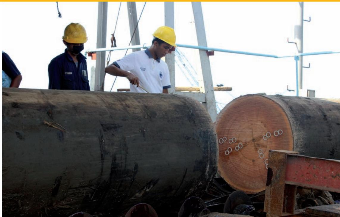
**En la cuna:** Aplicación de clavos de plástico para evitar rajaduras en los extremos de trozas de meranti para enchapado, Probolinggo, Indonesia.
