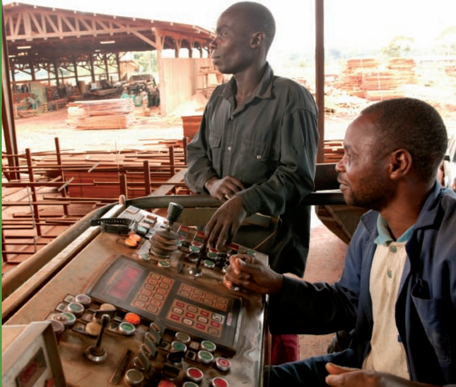
Cabine de contrôle d'une scierie, République du Congo. © Danzer AG, Baar
