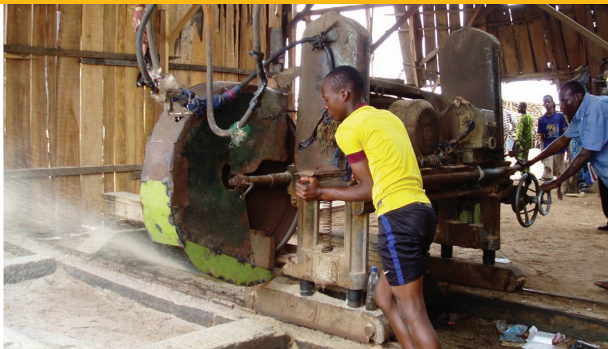
À la force des bras: des opérateurs poussent une scie à ruban horizontale à travers une grume. Photo. V. Molinos
