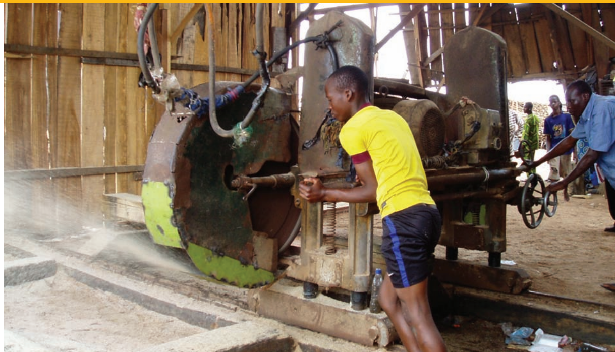
Fuerza obrera: Dos operarios empujan una sierra de cinta horizontal para el aserrado de una troza. Fotografía: V. Molinos
