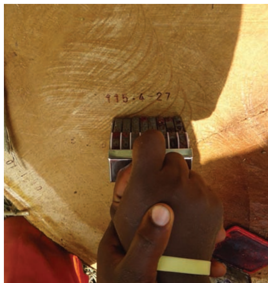
... et numérotés: dispositif de numérotation des sciages.
