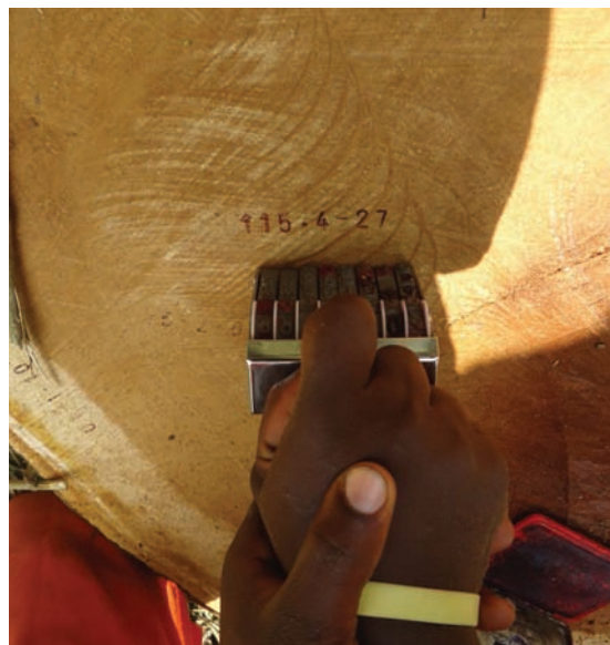
...y numeración: Dispositivo para numerar la madera aserrada.
