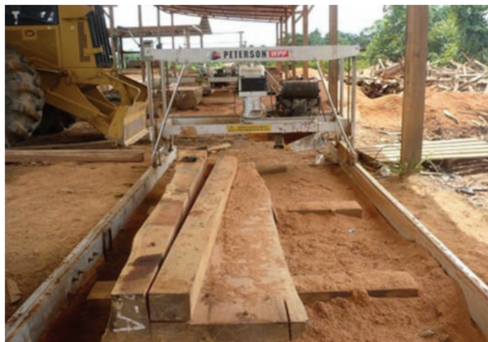
Sierra del bosque: Aserradero portátil en un patio de trozas de un bosque de Madre de Dios. Fotografía: Maderya
