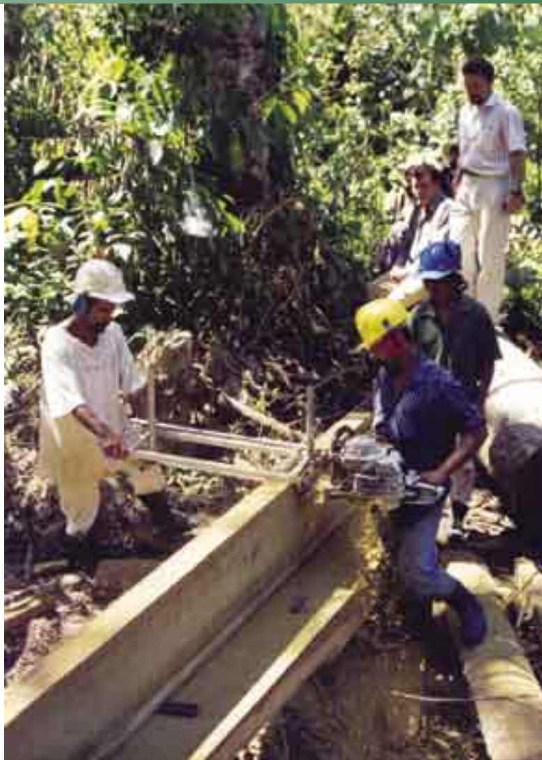
Encadrement: le personnel du projet évalue dans quelle mesure il est pratique et efficace d'utiliser des scies à chaîne avec cadre.
