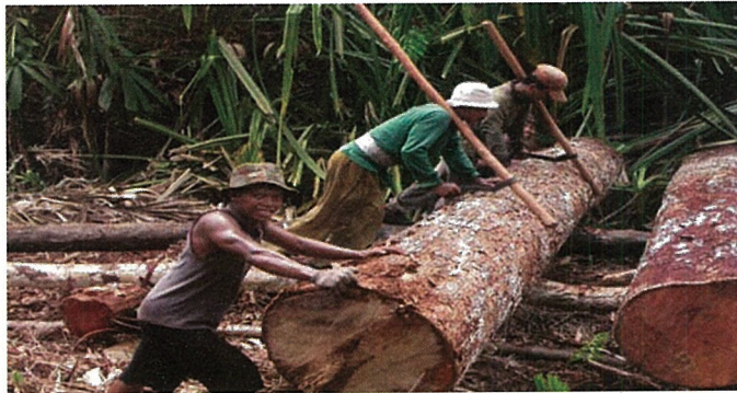
Gambar 7. Penyaradan kayu dengan kuda-kuda, dari tempat penebangan ke TPn.
