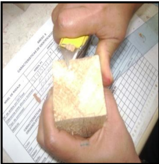
Corte en la sección del plano para obtener la distribución de los poros.
