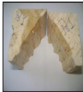
Se hizo un corte a la mitad del cubo siguiendo la dirección de los radios para determinar el grano
