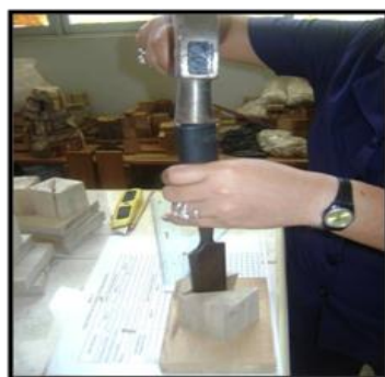
Se hizo un corte a la mitad del cubo siguiendo la dirección de los radios para determinar el grano
