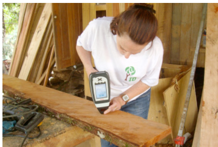
Un photospectromètre portatif est testé en conditions réelles dans une scierie à Manoel Urbano dans l'État d'Acre au Brésil. Photo: Jez Braga
