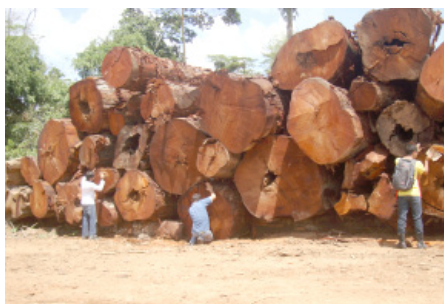
Une équipe de terrain prépare la surface du bois pour obtenir des spectres NIRS de l'acajou à l'exploitation Fazenda Seringal Novo Macapá dans l'État d'Acre au Brésil. Photo: Tereza Pastore
