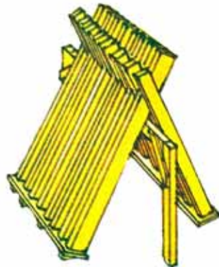
Figura 58. Apilado en talanqueras o caballetes
