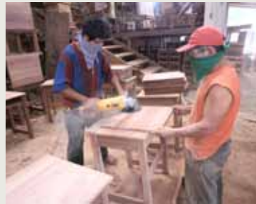
Figura 77. Lijado con lijadora excéntrica tablero de utucuro
