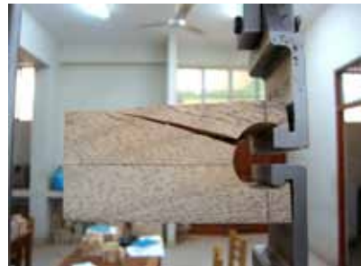
Figura 38. Resistencia al clivaje de panguana
