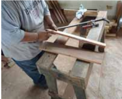
Pegado y encolado
