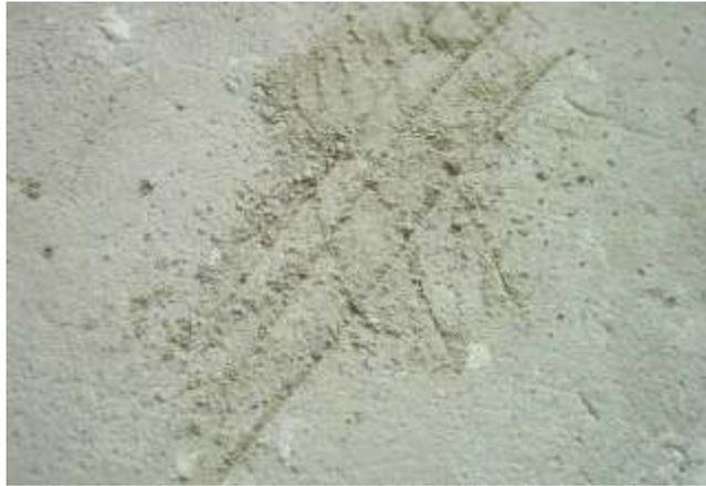
**Figura 20.** Teste de resistência do contrapiso utilizando riscos com prego.
