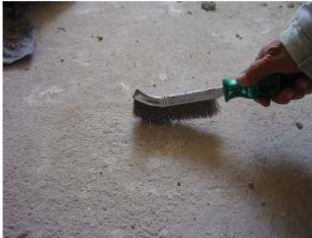
**Figura 21.** Teste de resistência do contrapiso utilizando escova de aço.
