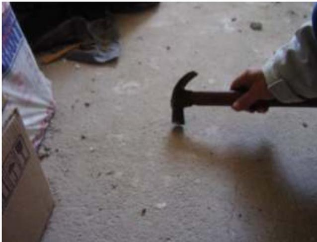
**Figura 22.** Teste de aderência utilizando martelo.
