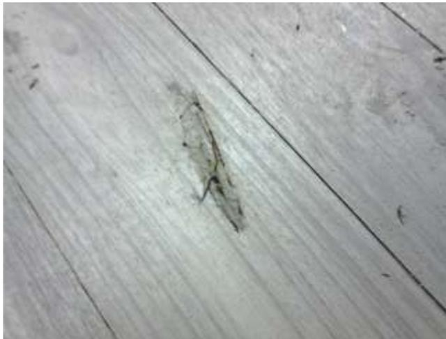
**Figura 58.** Falta de madeira na superfície da peça.
