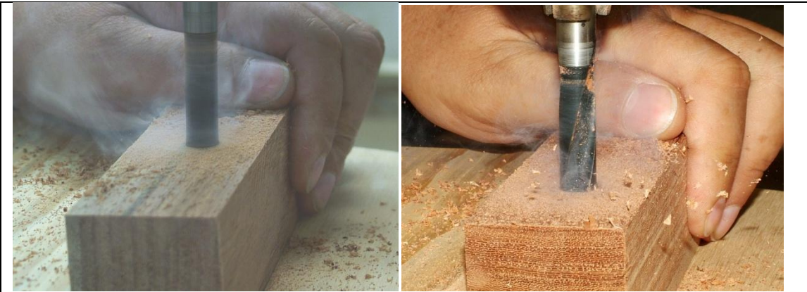
Figura 5. Quemado de la madera al barrenar a altas revoluciones.
