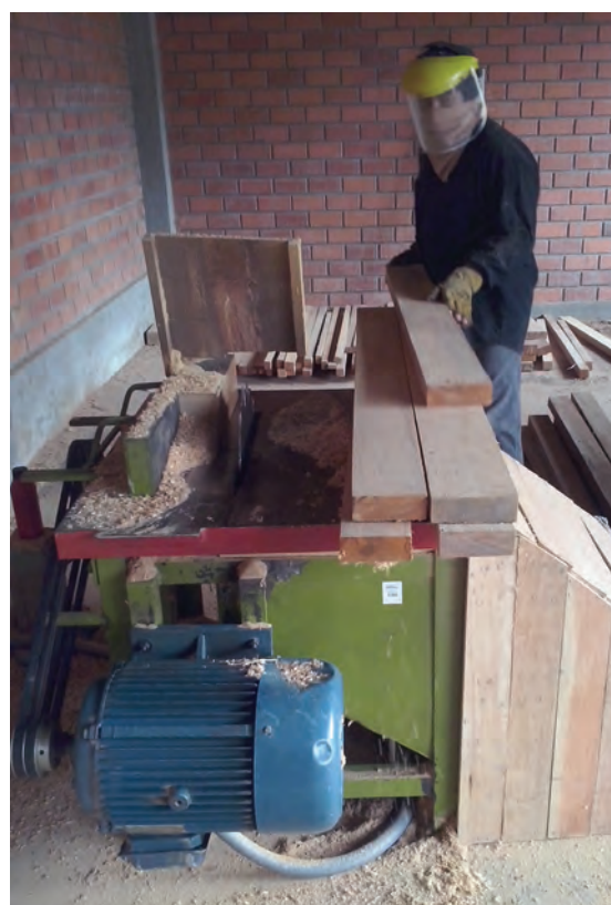
Corte al cepillo: Producción de tablas de madera cepilladas en la planta de transformación de Citeindígena S.R.L. Fotografía: AIDER
