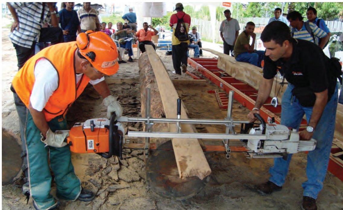
Guiando la guía: Los instructores demuestran el uso de guías en el aserrado para aumentar las tasas de recuperación de madera. Fotografía: P. Bholanath/GFC
