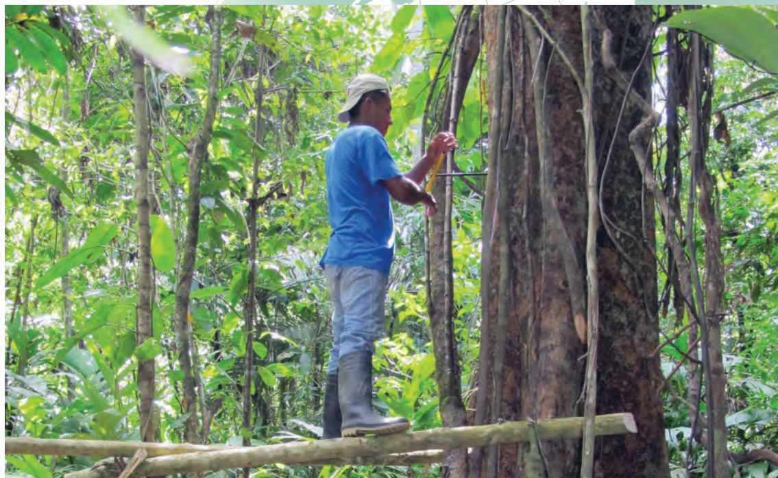
Barrenando: Un asistente extrae un núcleo de madera de un árbol de Carapa guianensis en la Región Autónoma del Caribe Norte de Nicaragua. Fotografía: D.R. Paguada Pérez
