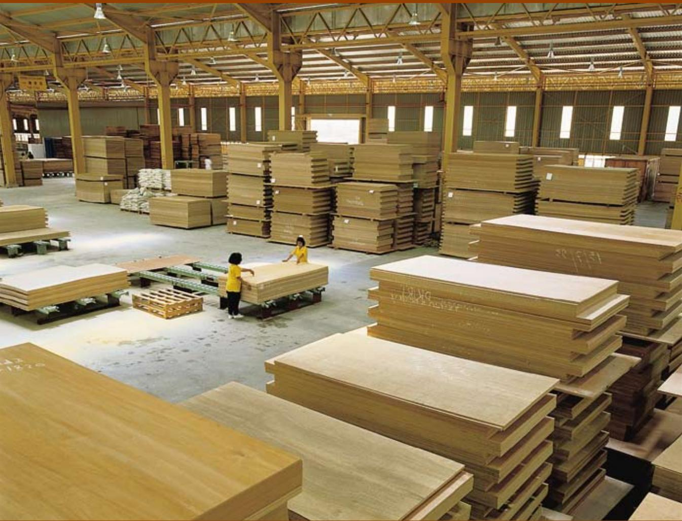
熱帯合板の硬化および検査
