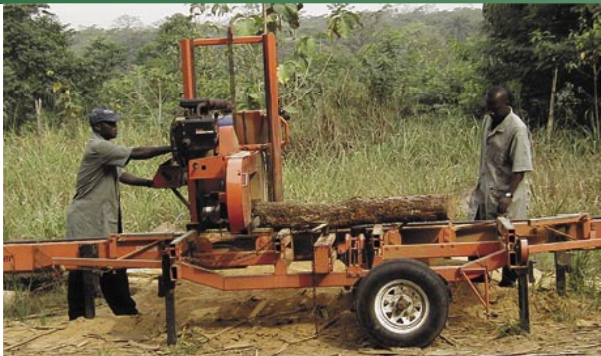
Economizando: el trozado primario de las ramas se efectúa con la sierra de banda móvil horizontal llamada “woodmizer”. Fotografía: © R. Okai
