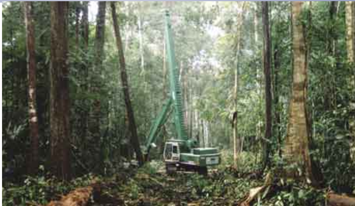
Extractor de madera Rimbaka en operación en el bosque de pantano cerca de Kuantan, Malasia peninsular. Foto: A. Sarre
