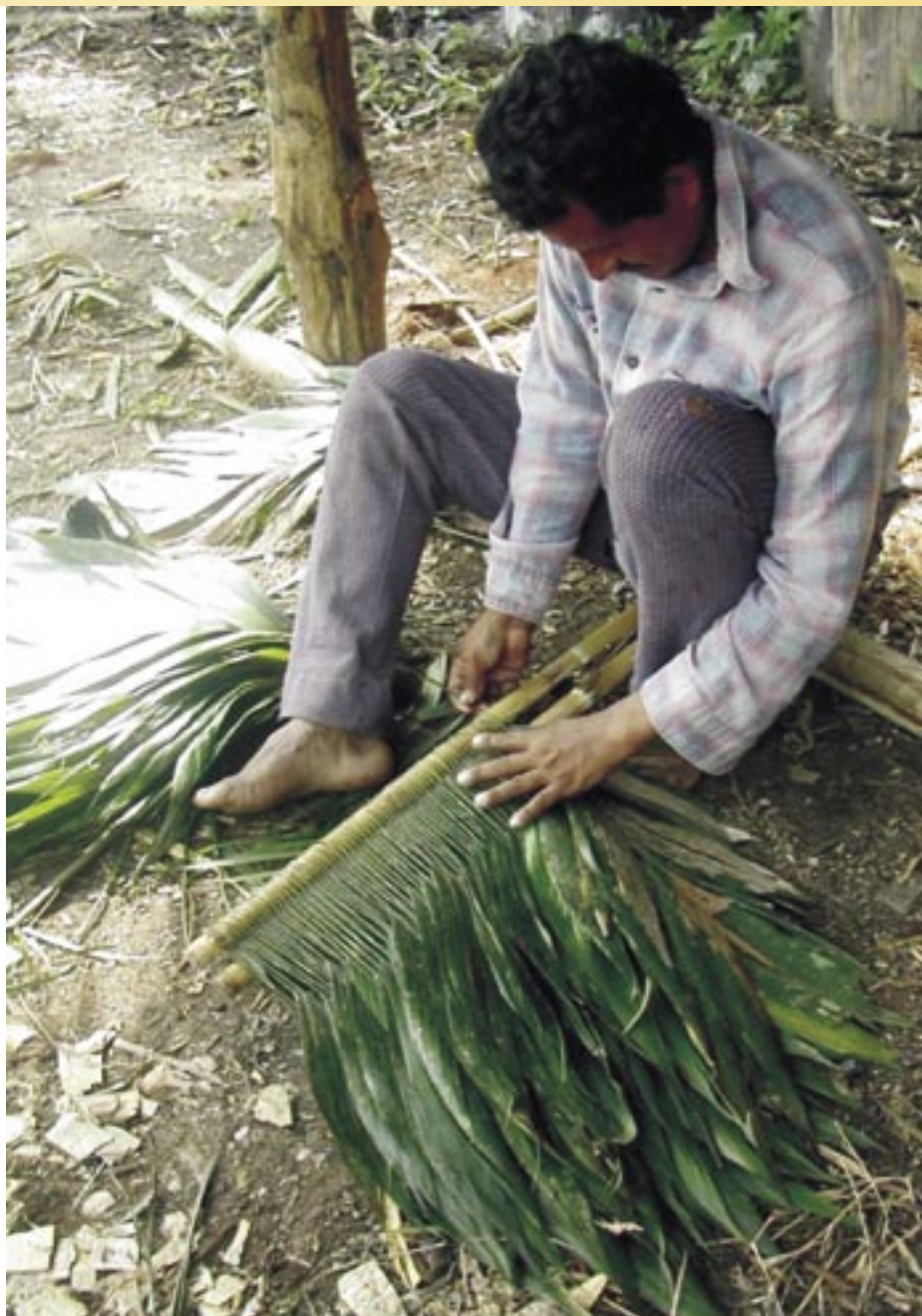
Produit forestier dominant: le palmiche est utilisé pour couvrir les habitations de chaume. Photo: C. Arellano
