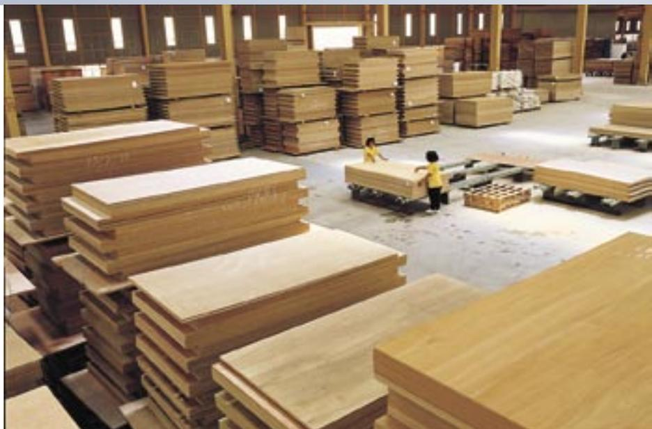
**Pilas:** láminas de contrachapados en Sarawak, Malasia, apiladas para curado e inspección antes de su exportación. Fotografía: cortesía de Samling Corp
