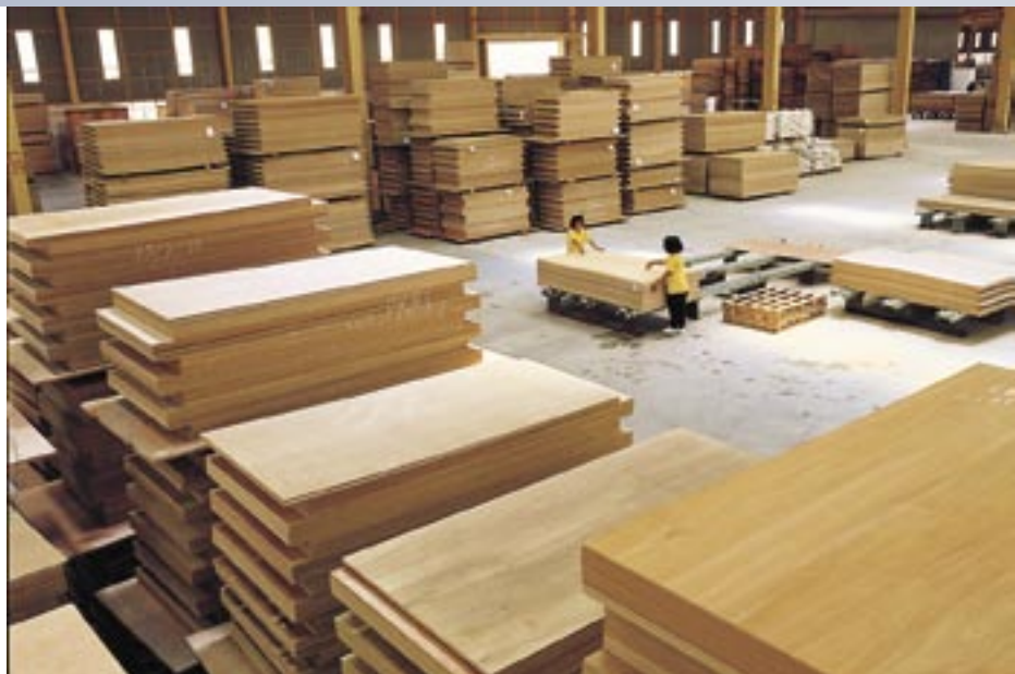
Empilement: plis de contreplaqués empilés pour traitement aux adhésifs et inspection avant l'exportation du Sarawak (Malaisie). Photo: Samling Corporation
